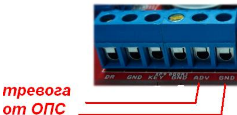
Рисунок 18 - Подключение внешнего сигнала тревоги
