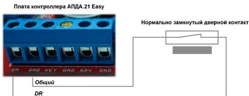
Рисунок 5 – Схема подключения дверного контакта
