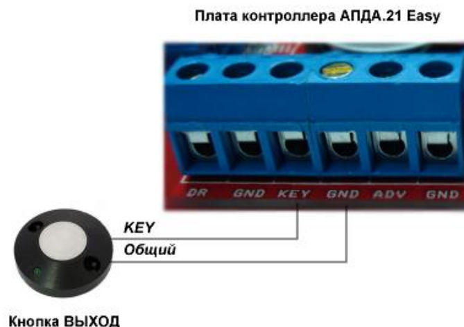
Рисунок 4 - Схема подключения кнопки "Выход"
