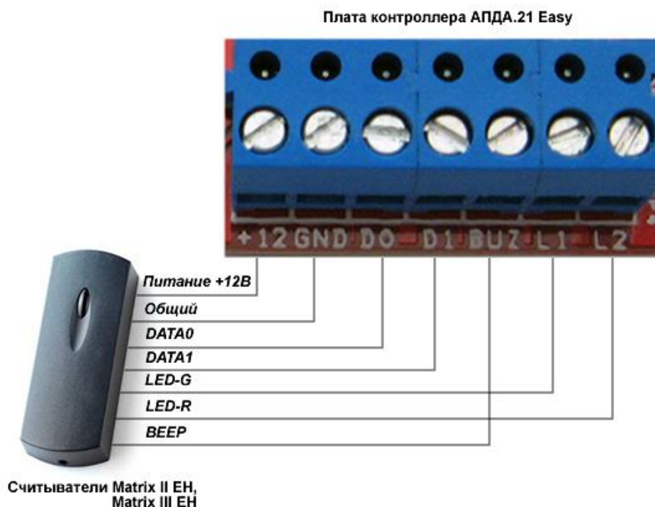
Рисунок 3 – Схема подключения считывателей
